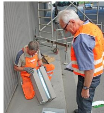
Demonstration des hier verwendeten Abdichtkissens SVS-QADK/V L im Funktionsmodell
